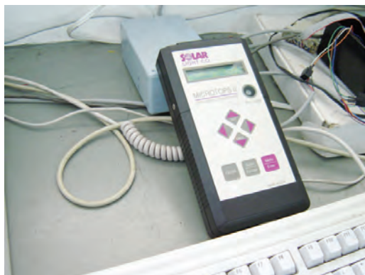
Figura 4. Ozonómetro Microtops II: es un fotómetro solar de 5 Canales. Tres de ellos miden radiación electromagnética en la Banda UV-B y dos miden radiación infrarroja de onda corta. De los datos que registran los canales UV-B, se deduce la columna De ozono total. De los datos que se registran en las bandas infrarrojas De onda corta se deduce la cantidad de agua precipitable y el espesor Óptico de aerosoles.
