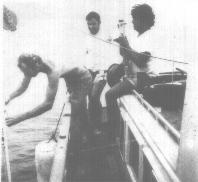
Personal del CCML lanza una serie de botellas Nansen durante los estudios sobre el afloramiento en el Golfo de Panamá en 1973.
